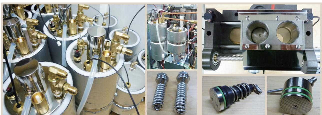
스테인리스 스틸 보일러와 히터(보일러 SUS 304, 히터 SUS 316) / 금속 피스톤 및 실린더(스테인리스 스틸)
